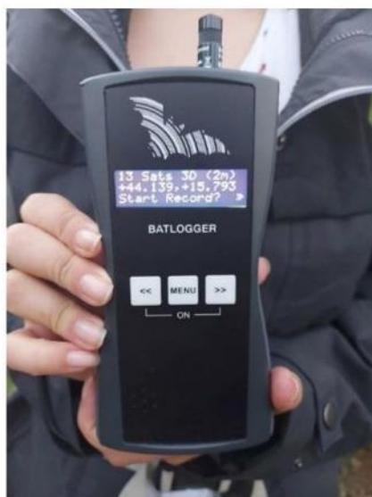
Slika 5 - Ultrazvučni snimač Elecon Batlogger M s kojim se snimaju eholokacijski signali na zadanim transektima
